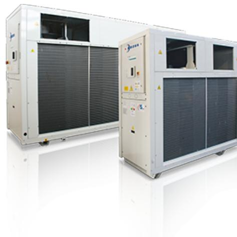
**Flüssigkeitskühler und kompakte umsteuerbare Wärmepumpen mit hohem Wirkungsgrad mit luftgekühltem Flüssigkeitskühler und Radialventilatoren des Typs Plug-Fan mit EC-Motoren. Baureihe mit hermetischen Scroll-Verdichtern und Kältemittel R410A.**
